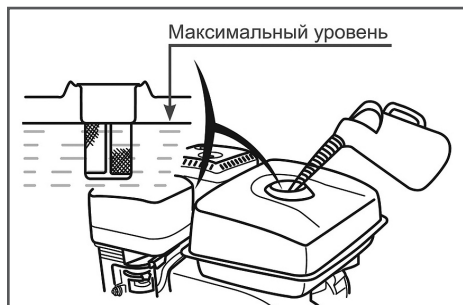
Рис. 9 Максимальный уровень топлива в топливном баке
